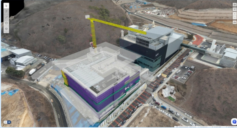
건축 BIM 모델과 드론으로 생성한 3D 메쉬 모델을 비교하여 건물간 간섭 검토
