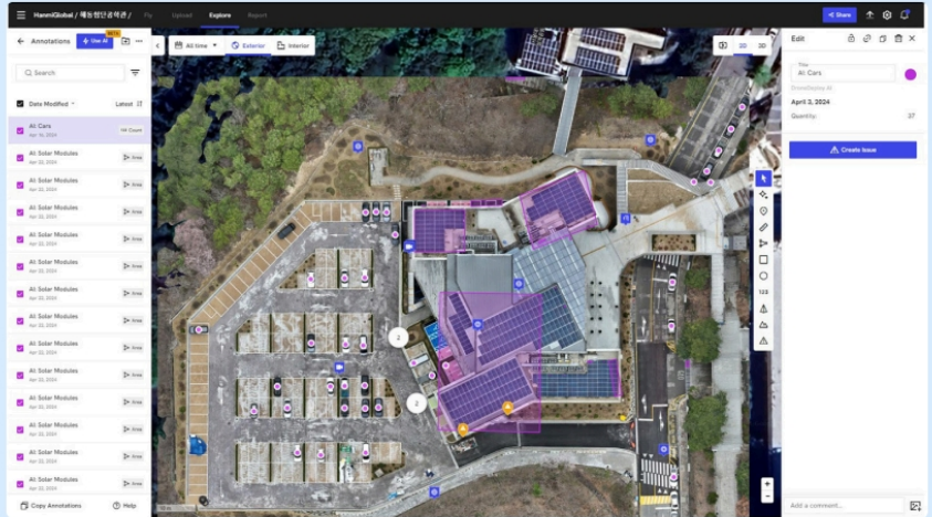
AI 기능을 활용하여 태양광 패널 시공 위치 자동 파악 및 주차대수 자동 계산
